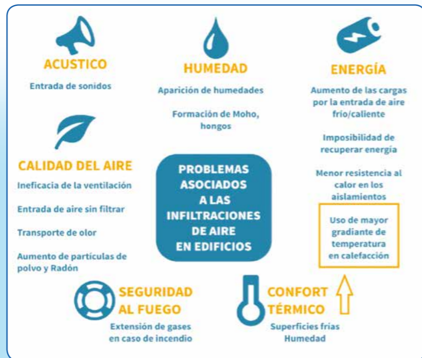
Cuadro resumen de problemas asociados a las infiltraciones de aire.
