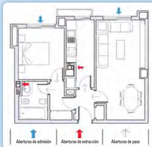
Esquema de ventilación de una vivienda.
